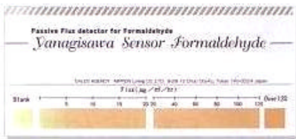
ホルムアルデヒドの放散量による色調変化
